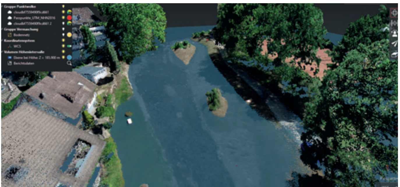
Abb. 63: Überflutungsanalyse bei verschiedenen Wasserständen
