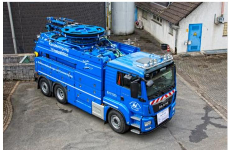
Fahrzeug für die Sinkkastenreinigung
