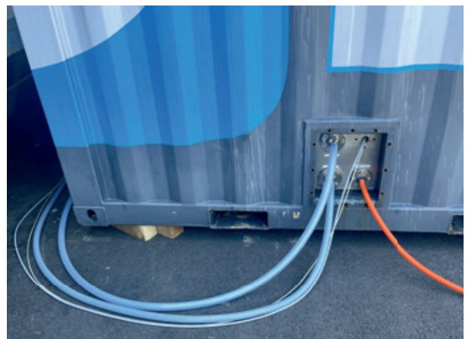
Abb. 67: Anschluss-Port MOPAK an WWE mit Wasserzuführung, PAK-Emulsion-Dosierleitung und SPS-Anbindung
