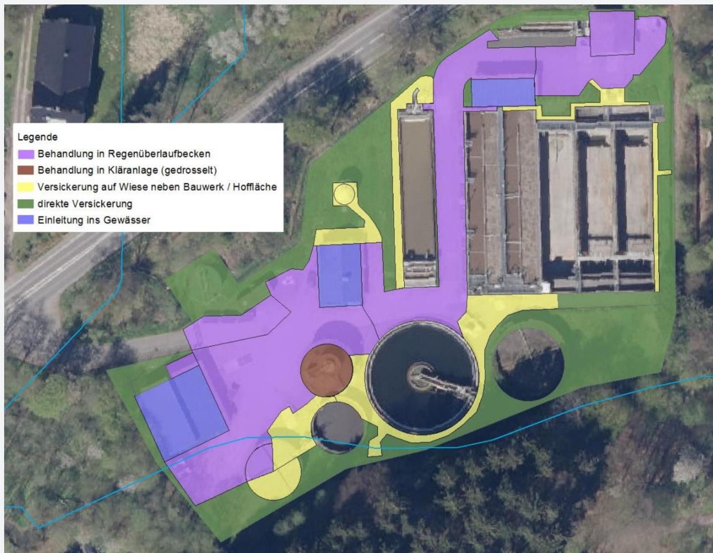
**Abbildung 62:** Oberflächenentwässerung Kläranlage Lindlar
