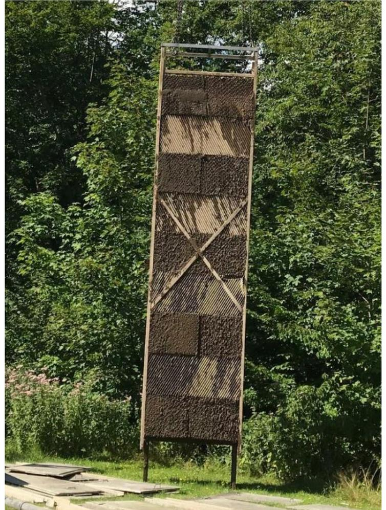
**Abbildung 46:** Ausgebautes Festbettelement. Die Belüfter befinden sich jeweils darunter
